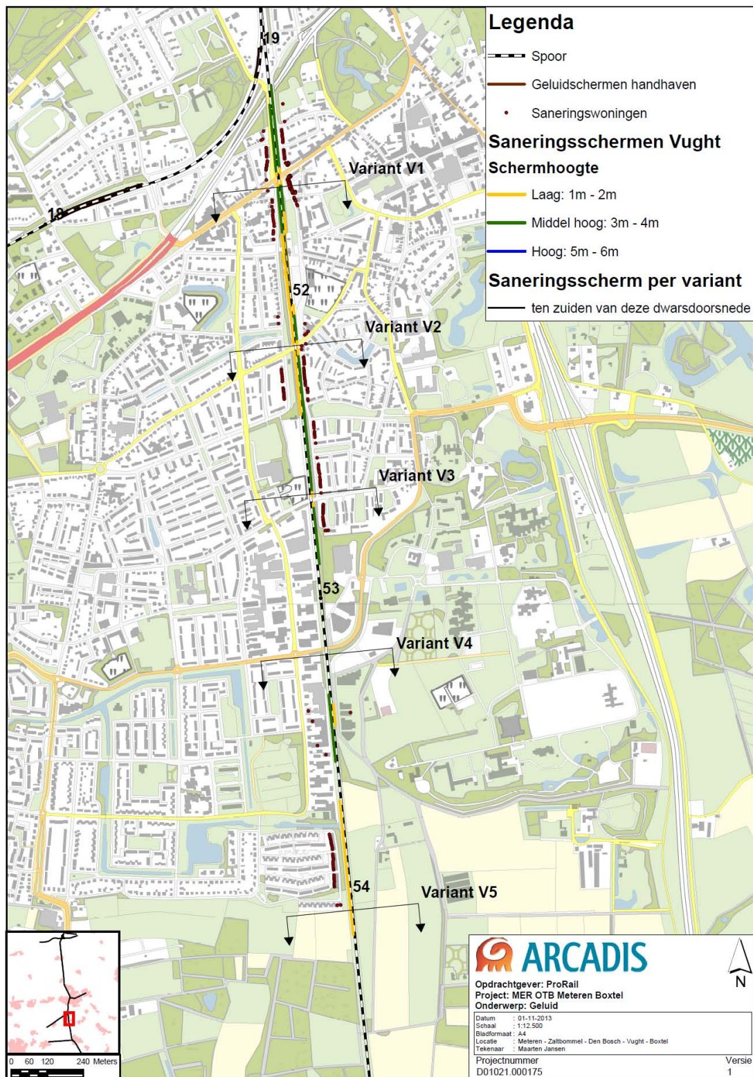
Abbeelding 18: Saneringsschermen in Vught (In Bijlage 4 is deze afbeelding in groter formaat te zien).
