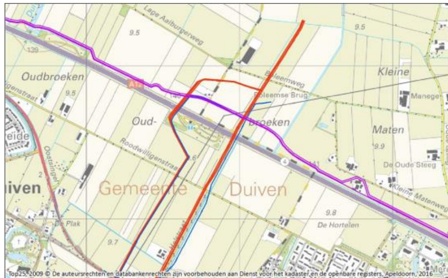
Figuur 6.14: Positionering tracé Gasunie/Vitens (rood+blauw) en Waterschap Rijn & IJssel/Vitens (paars) [13]
