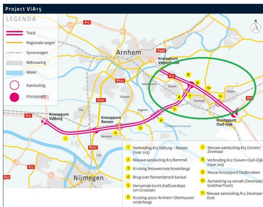
Figuur 1.1: Overzicht verlenging van de A15 en de aansluiting van de A15 op de A12. De verlegging van de kabels en leidingen vindt globaal plaats binnen de groene cirkel [11].
