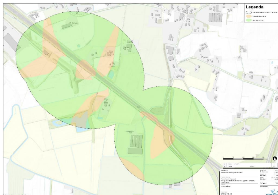
Figuur 7.48: Krimpricocartaat project Liander-Hazenpad: aanleg 10kV kabels en 100 mBar leiding, parallel aan de A12 nabij Zevenaar.
