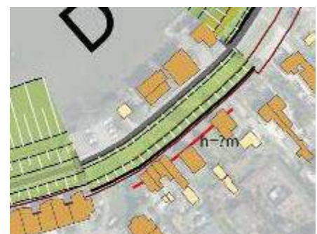
Figuur 16 Damwand over 105 m. in het zicht
