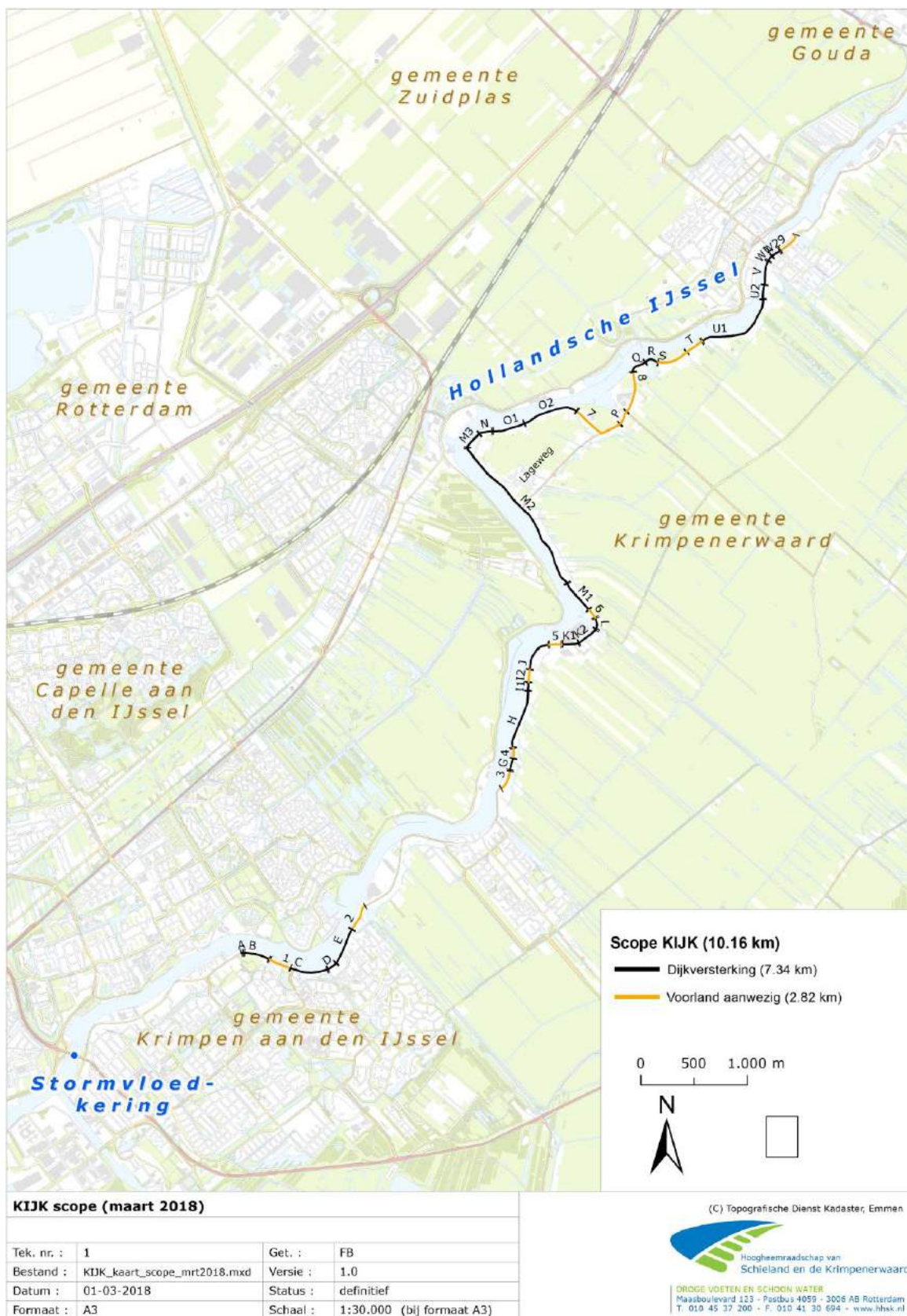
Figuur 7 KIJK scope waarvan 29 dijkvakken aangeduid met letters A t/m W en 9 stukken voorlanden aangeduid met cijfers 1 t/m 9
