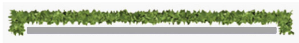
Bovenaanzicht principe geluidsschermen "inpakken" met haag
