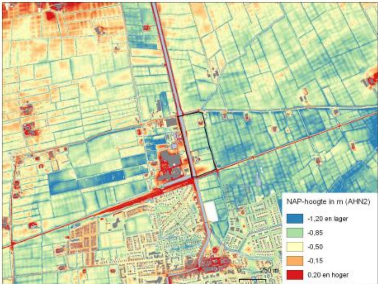
Figuur 28: Hoogteverschillen in en rondom het plangebied (AHN2). De ligging van het plangebied is aangegeven met een zwarte omlijning
