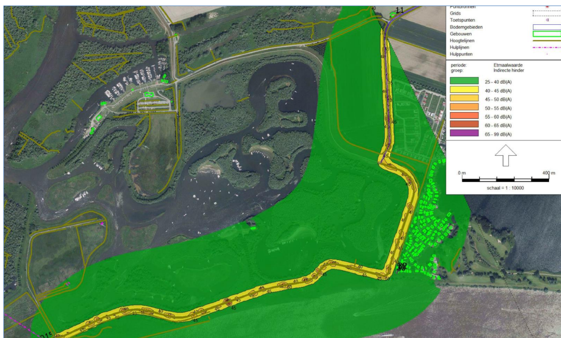
Afbeelding 29: Geluidcontouren aan- en afvoer aanlegfase (vrachtverkeer)
