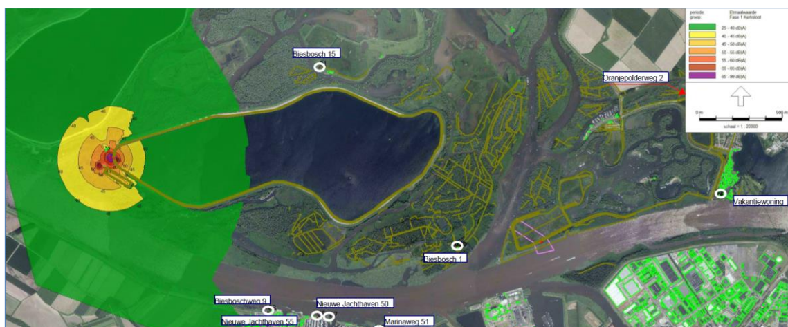
Afbeelding 25: Geluidcontouren prefabriceren leidingen bij de Kerkvloot
