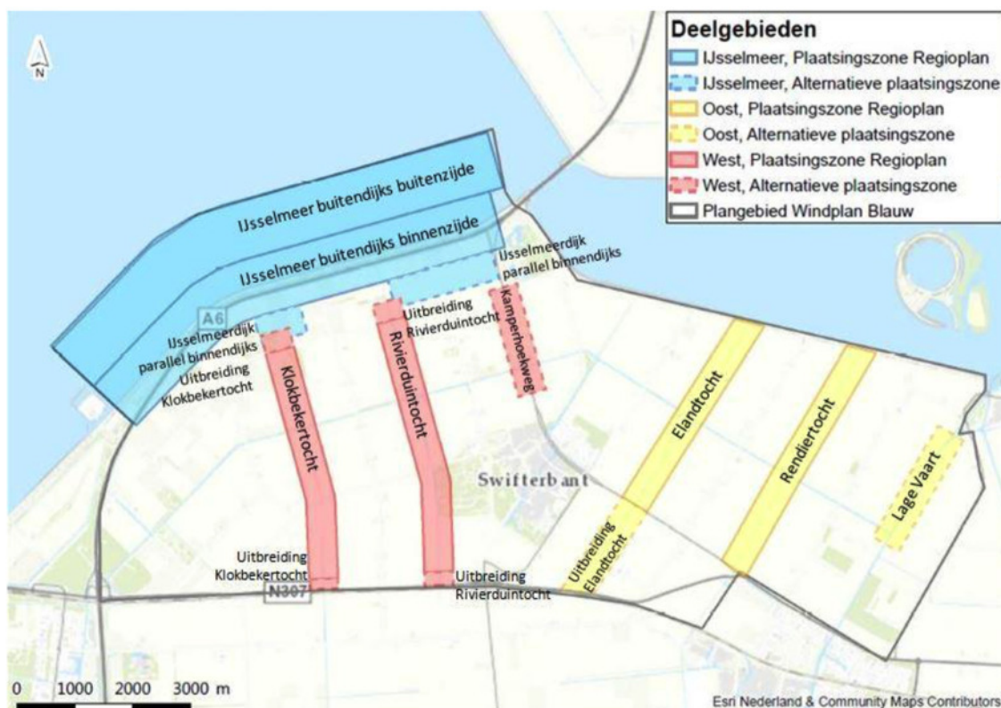
Figuur 2.1 Plaatsingszones windturbines Windplan Blauw
