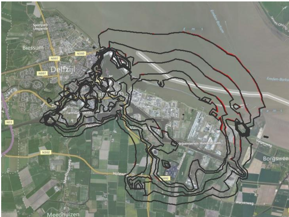
Figuur 57 Vergelijking tussen de geluidscontouren van Oosterhorn in de huidige situatie (zwarte contouren) en de geluidscontouren in de nieuwe situatie met daarbij de derde lijn van EEW toegevoegd zonder geluidsreducerende maatregelen (rode contouren).
