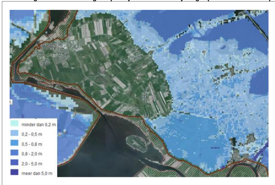
Afbeelding 4.5. Overstromingsdiepte bij het falen van dijkkring 9 (www.risicokaart.nl)
