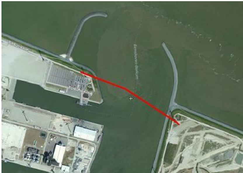
Figuur 24 HDD route (rode lijn) in het Doekegat (ingang van de Eemshaven).
