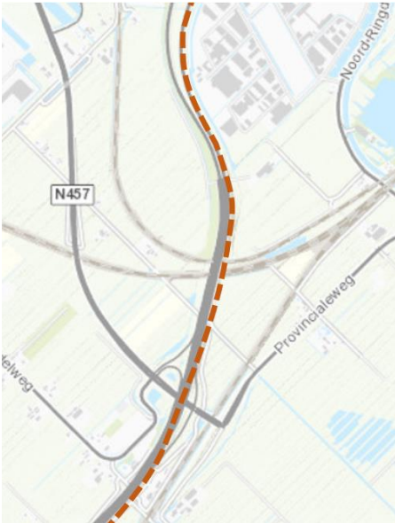
Figuur 9: Principe van de voorgestelde verschuiving in oostelijke richting in wegvak 2
