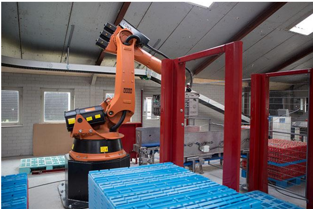
Figuur 2.3 Eieverwerkingsruimte met inpakrobot
