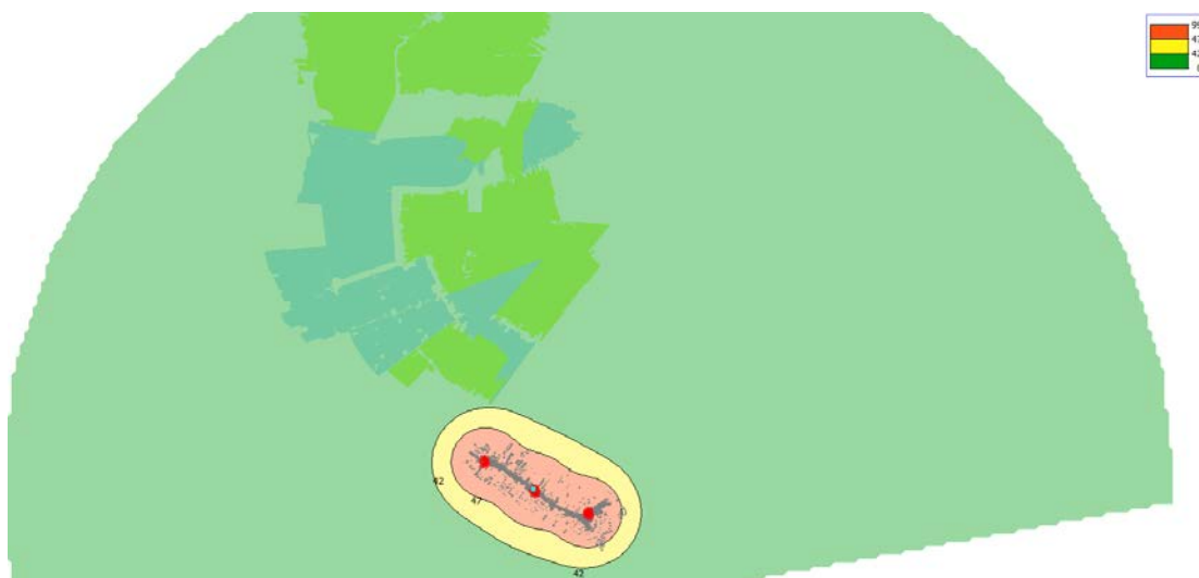
Figuur 5.1 Geluidscontour aanlegfase
