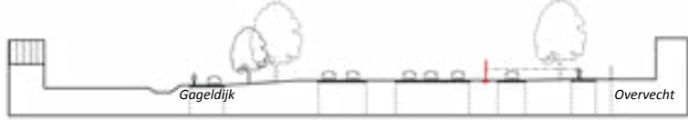
Optie 3 | Maaiveld tussenliggende wegvakken met geluidsscherm 3,0 m Overvecht
