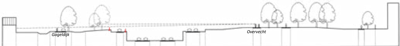
Optie 2 | Onderdoorgang met geluidsscherm 1,2 m Gageldijk
