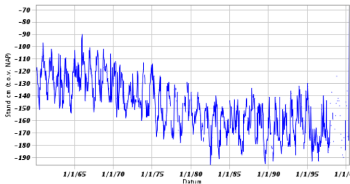
Figuur 3.18 Verloop van de grondwaterstand van peilbuis B11B0215-001 in Groote Veenpolder Opsterland ten westen van Boornbergummerpetten vanaf 1951
