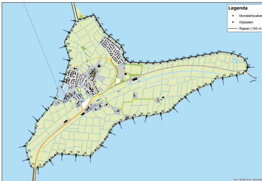
Figuur 4.5 De raaian met monsterpunten voor mosselonderzoek loodrecht op de kust van Marken. Voor het bepalen van de locaties is gebruikgemaakt van de dijkpaalbenummering. Nummer 1 is de zuidzijde van de haven, de nummering is verder tegen de klok in. 1-12 liggen aan de zuidelijke helft van de westkust, 13-46 aan de zuidzijde van Marken tot het oostelijkste punt, 47-74 aan de noordzijde en 75-85 tenslotte ten Noorden van de havenmond aan de westzijde.
