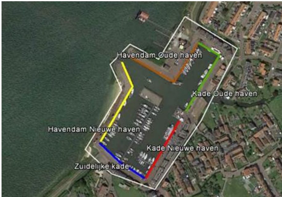
Figuur S.21 Aan te passen damwanden binnen de haven. De in bruin, groen, rood en blauw aangegeven kadedelen worden aangepast.
