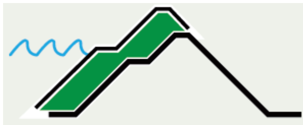
Afbeelding 2.5 Schema ophoging buitenwaarts
