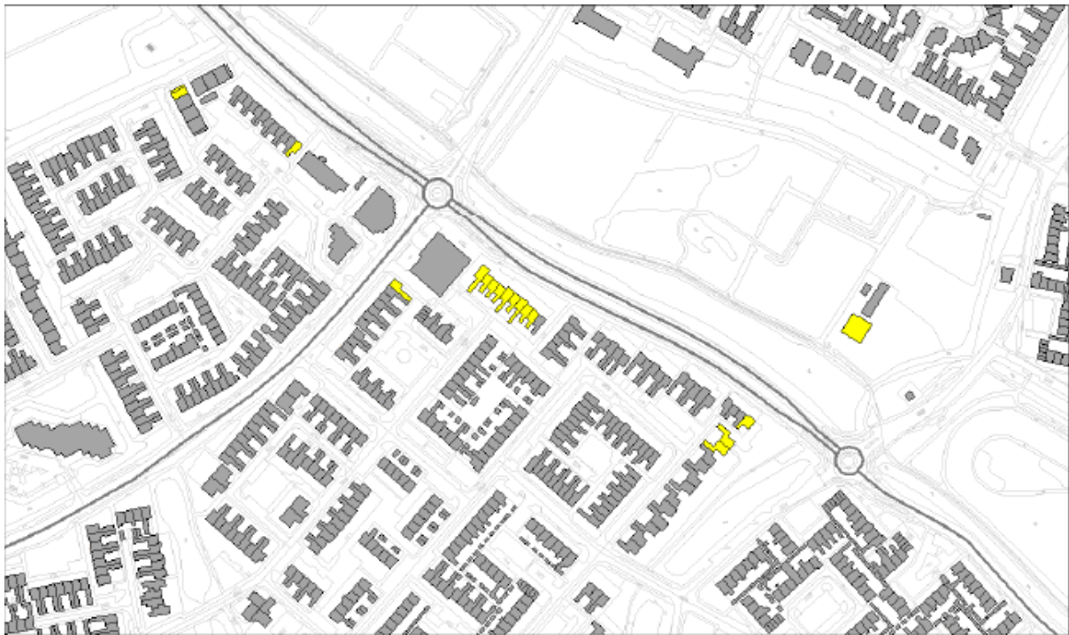
Afbeelding 5.4E: Woningen waarvoor ten gevolge van de Dijkgraaf Poschlaan een reconstructiesituatie in de zin van de Wet geluidhinder berekend is, met toepassing van geluidsreducerende asfaltverharding
