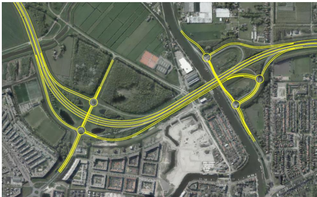
Figuur 5: principe 2 halve aansluitingen met parallelstructuur aan oostzijde
