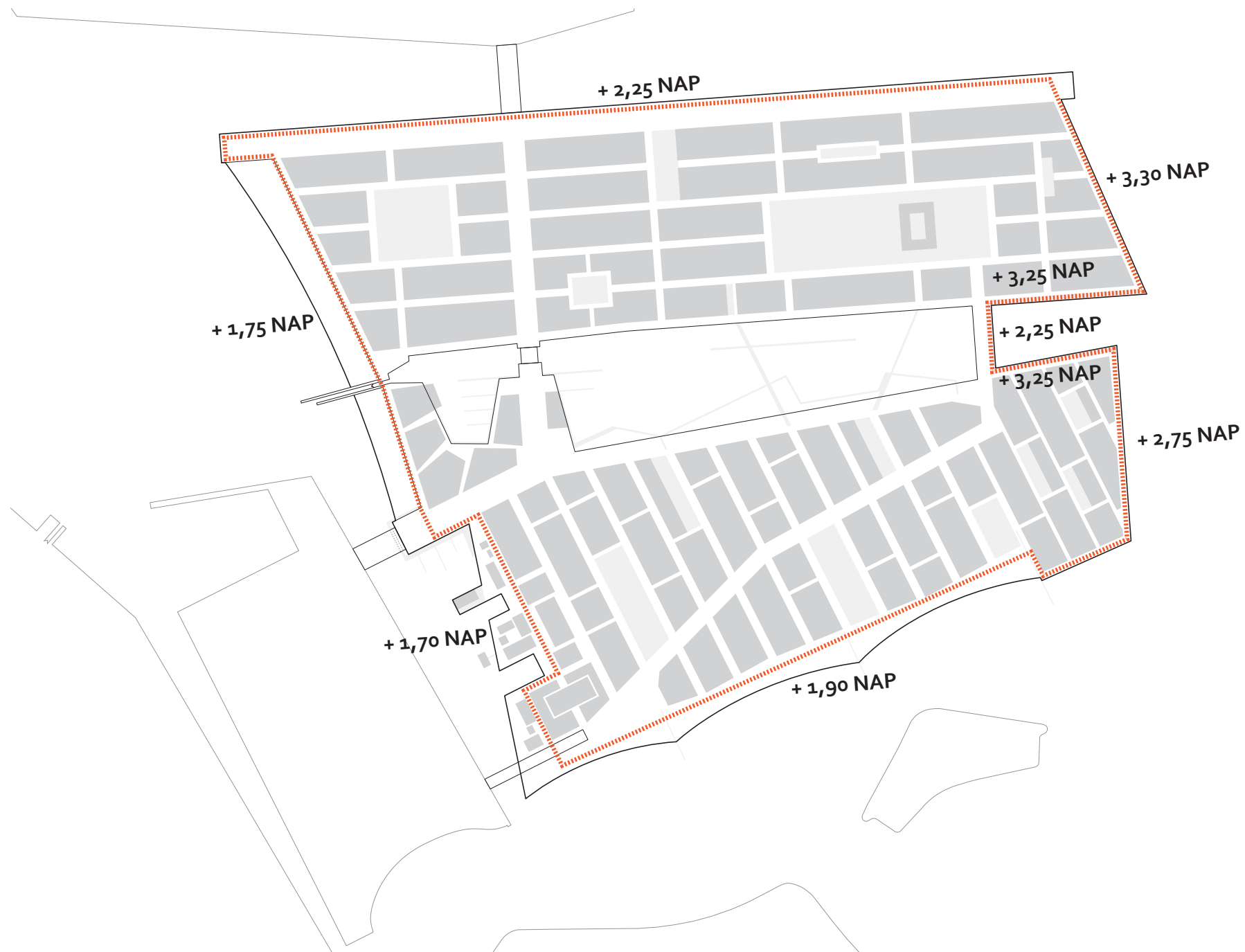
Afb. 10.5 Plankaart met schematische weergave van de waterkeringen
