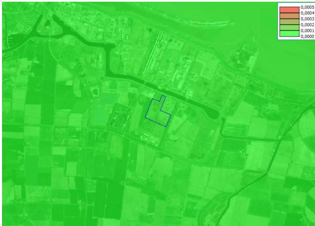
Figuur 6.6 Bronbijdrage benzo(a)pyreen aan de jaargemiddelde concentratie ten gevolge van Verda in \mu\text{g}/\text{m}^3
