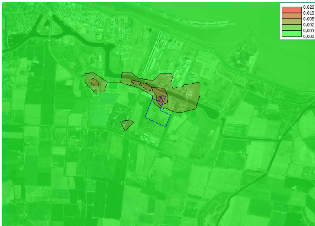
Figuur 6.5 Bronbijdrage benzeen aan de jaargemiddelde concentratie ten gevolge van Verda in \mu\text{g}/\text{m}^3
