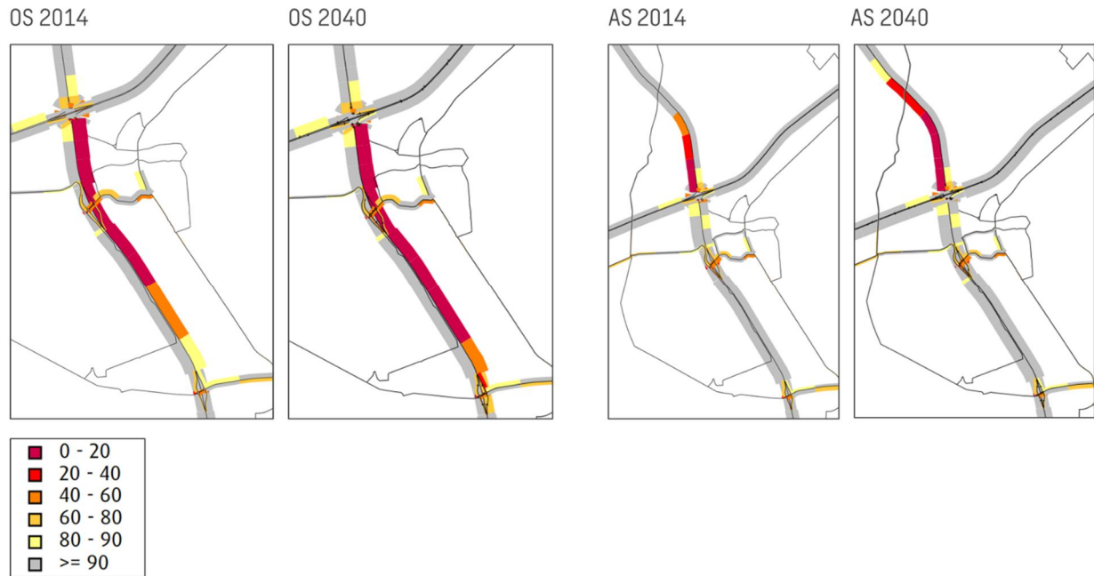
Figuur 4.11 Verkeersafwikkeling rond verkeersplein Gieten. De kleuren laten zien welke snelheid wordt gerealiseerd (paars/rood is lage snelheid).
