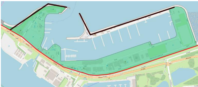
Figuur 13: De haven van Lauwersoog. De primaire waterkering is weergegeven met de rode lijn en havendammen zijn weergegeven met de zwarte lijnen. De groene vlakken zijn de hooggelegen voorlanden.
