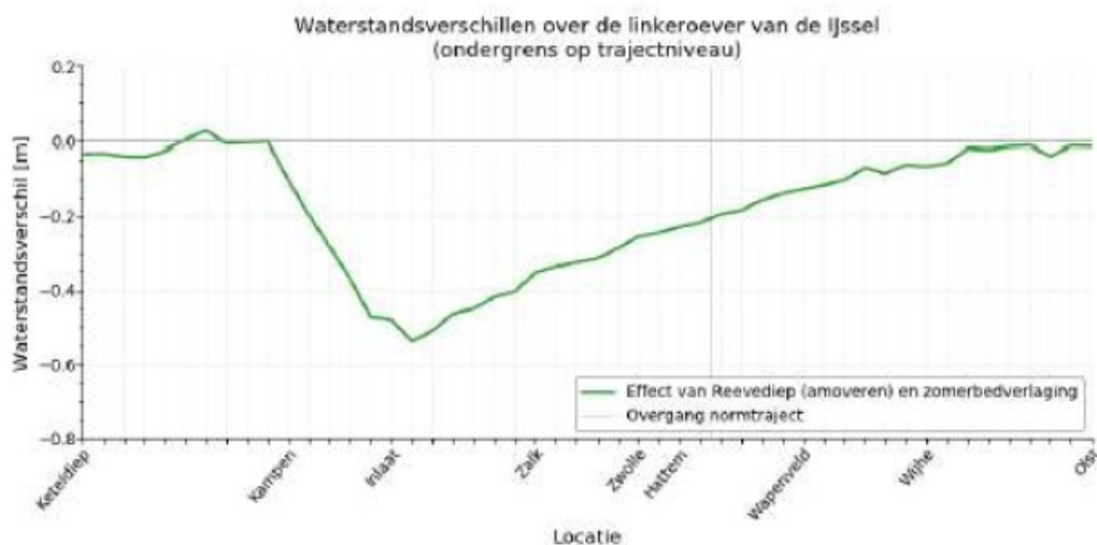
Figuur 22a: waterstandverschillen over de linkeroever van de IJssel
