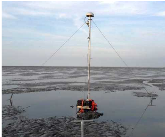
Figuur 7: Meetopstelling jaarlijkse GNSS monitoring
