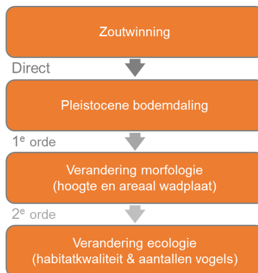
Figuur 2-3 Schema met de onderlinge afhankelijkheid tussen Zoutwinning, Pleistocene bodemdaling en veranderingen in de morfologie en in de ecologie.
