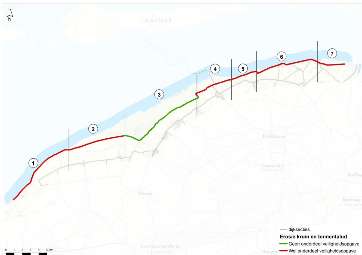
Afbeelding 2.7 Erosie kruin en binnentalud
