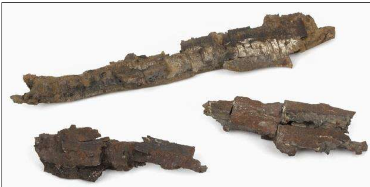
Figuur 36. Scherven afkomstig van een projectiel dat was gevuld met springstof, na detonatie.
