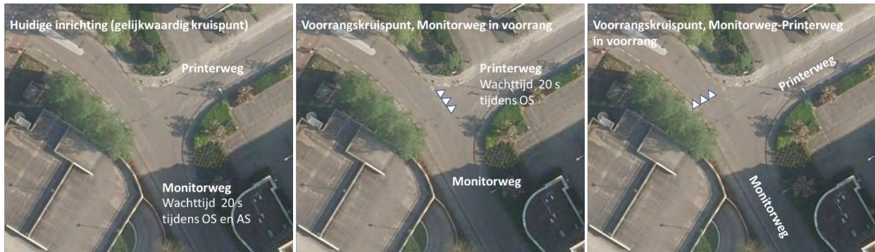
Figuur 28 Inrichting kruispunt Monitorweg-Printerweg met: huidige inrichting (links), Monitorweg in voorrang (midden) en Monitorweg-Printerweg in voorrang (rechts)
