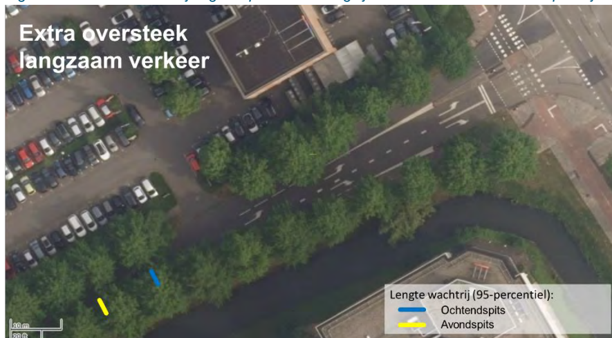
Figuur 19 Maximale wachtrijlengtes op de Plotterweg tijdens de ochtend- en avondspits met een extra oversteek voor langzaam verkeer aan de noordzijde van het kruispunt Outputweg-Plotterweg
