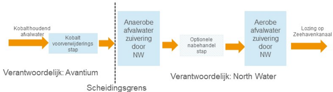
Afbeelding 5.2 Verwerking van kobalthoudend afvalwater
