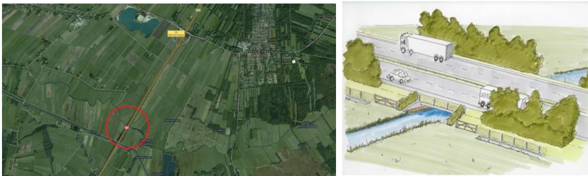
Figuur 8.5. Locatie van de onderdoorgang (links) en impressie hoe de onderdoorgang het eruit komt te zien (rechts) (bron: Wetterskip Fryslân)
