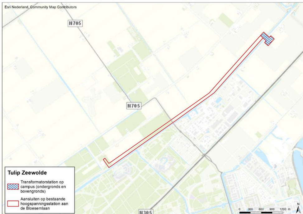
Figuur 3-30 Zoekzone hoogspanningsverbinding naar bestaand hoogspanningsstation Bloesemlaan
