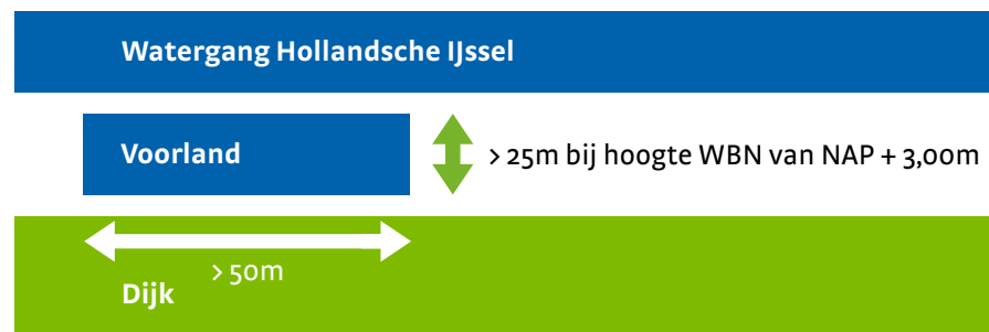
Figuur 2-7: Bovenaanzicht met de ligging van de dijk, met voorland en watergang Hollandse IJssel, volgens de definitie 'Brede en hoge voorlanden'.
