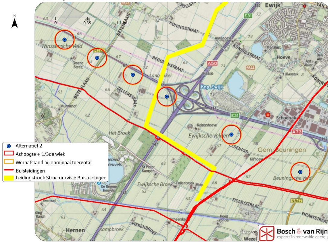
Figuur 9 Buisleidingen en adviesafstanden Gasunie
