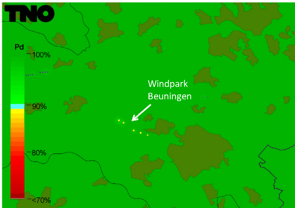
Figuur 8 Detectiekans van het primaire verkeersleidingsradarnetwerk op 1000 voet boven het bouwplan nadat deze is gerealiseerd. De locatie van de nieuwe windturbines is aangegeven met gele stippen.
