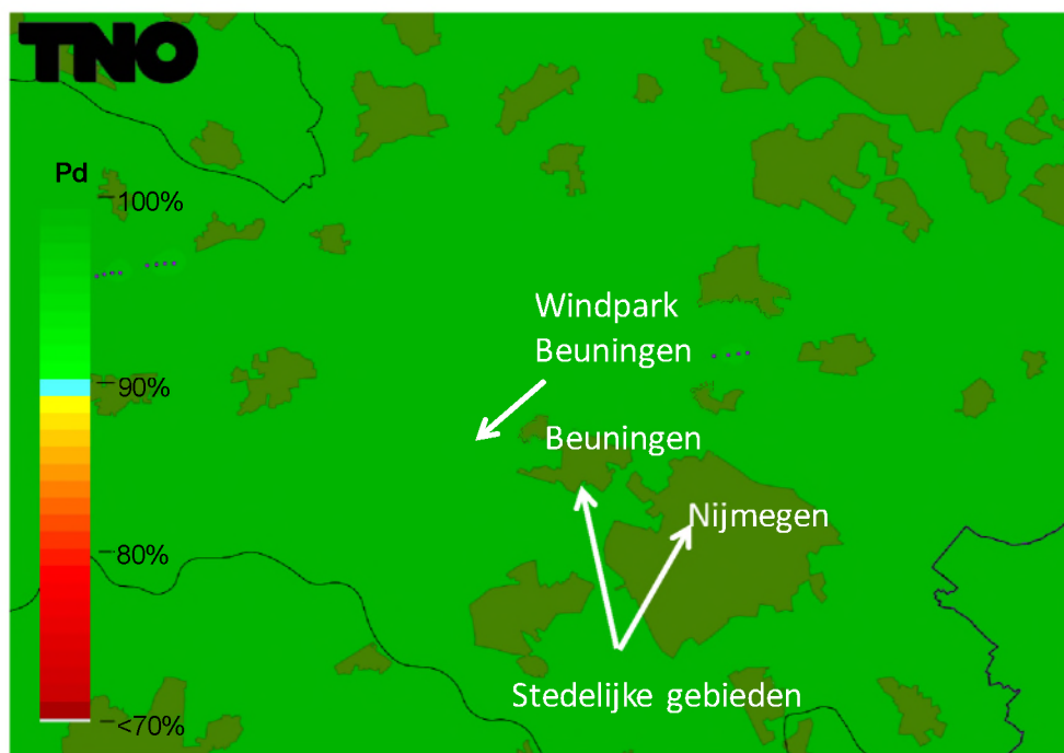
Figuur 10 Detectiekans van het primaire verkeersleidingsradarnetwerk op 1000 voet boven het bouwplan voordat dit is gerealiseerd (baseline).
