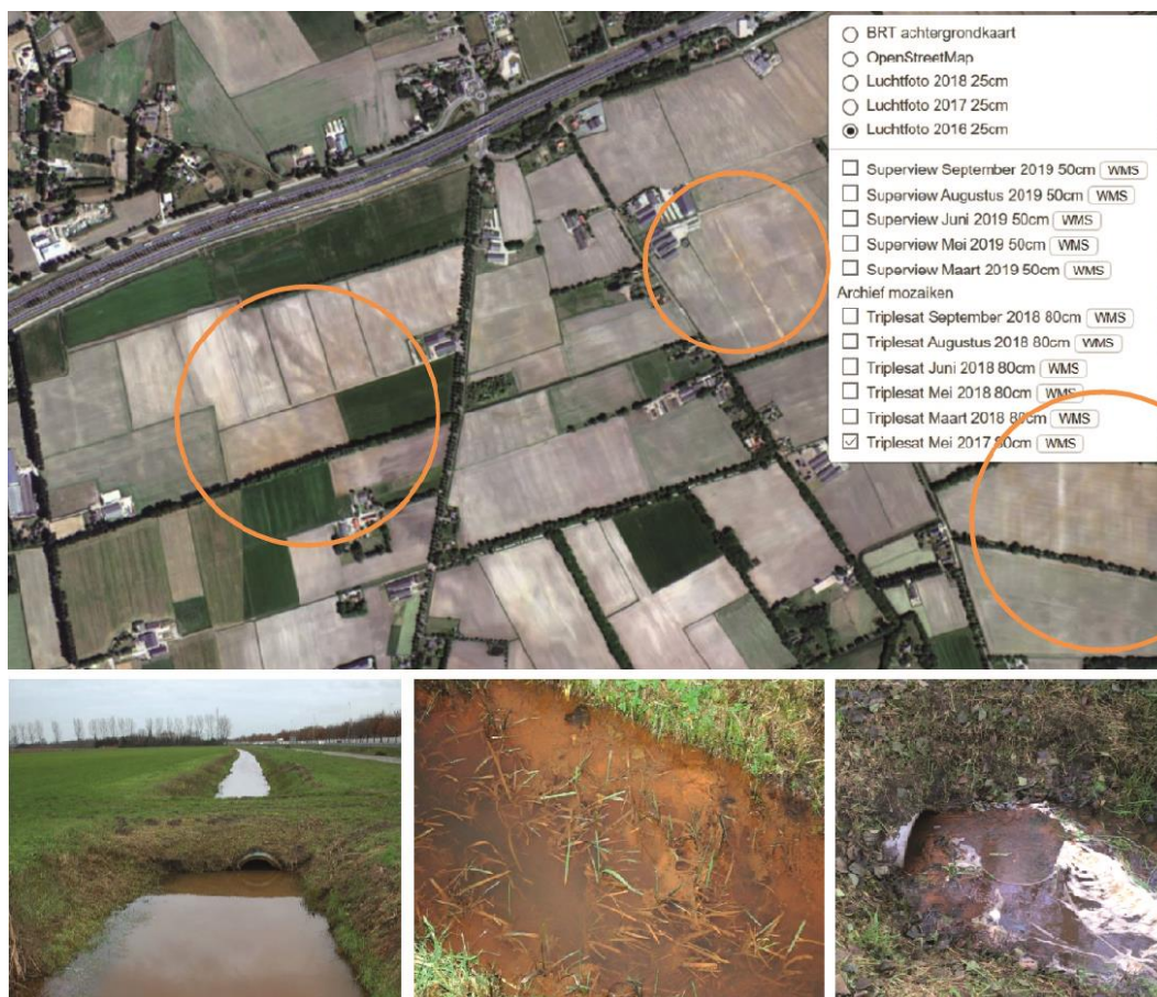
Figuur 15.5 Aanwijzingen voor de aanwezigheid van breuklijnen door roodbruine verkleuringen op percelen en in sloten (bron: Landslide milieu-adviesbureau)
