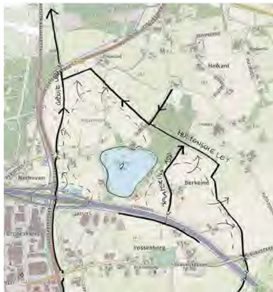
Het huidige watersysteem met de afstroom van regenwater van hoog naar laag.
