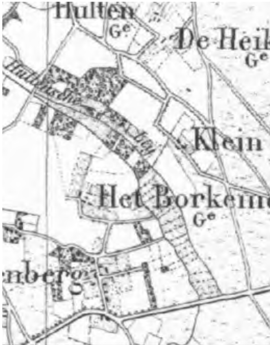
Principe van bevoeiing in het beekdal van de Hultensche Leij in 1850: Kwelzone aan de oostkant in aangesneden en via een greppels worden de beemden bevoeid.
