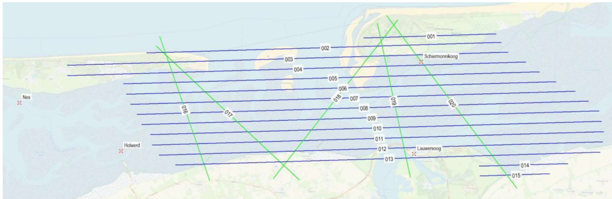
Figuur 4: Vluchtlijnen voor het uitvoeren van de LIDAR-opname in Pinkegat en Zoutkamperlaag. De groene vluchtlijnen dienen ter controle en kalibratie van de LIDAR-opname. Deze lijnen verbinden vaste reflectiepunten op het land waarvan de hoogte bekend is. Ontleend uit Terratec-rapport 41067.
