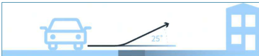
Afbeelding 5.4 Werking van een diffractoren langs een weg (bron: 4silence.nl)
