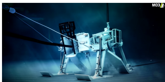
Figuur II: voorbeeld van ploeg met jetting optie geactiveerd – de SMD-MD3 Ploeg
