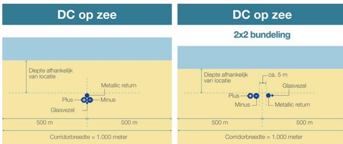
Figuur 2.2 Corridorbreedte van één kabeltracé op zee (met links de 1x4 kabelconfiguratie en rechts de 2x2 kabelconfiguratie)
