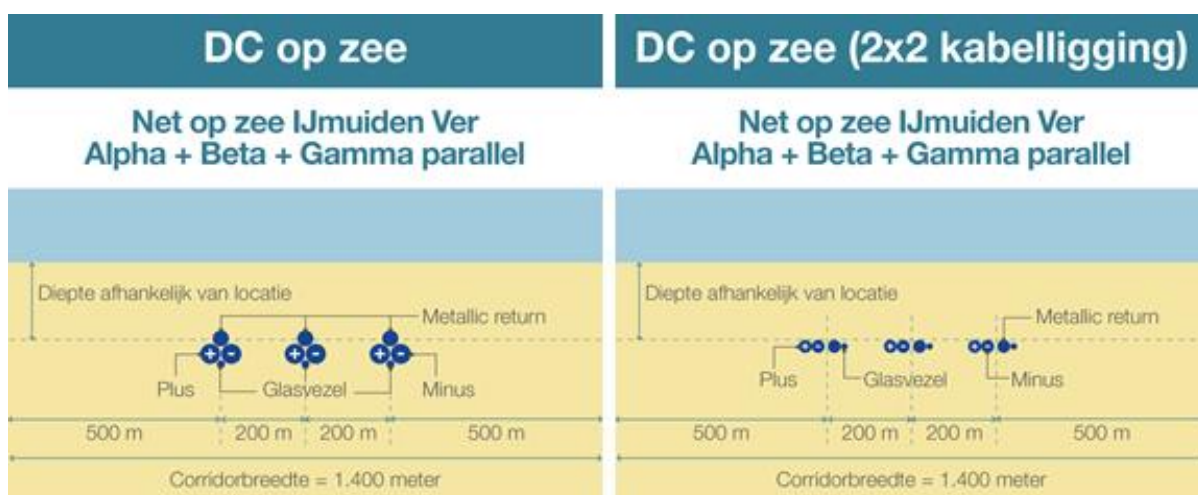
Figuur 2.3 Breedte corridor op zee bij parallelligging van drie kabeltracés
