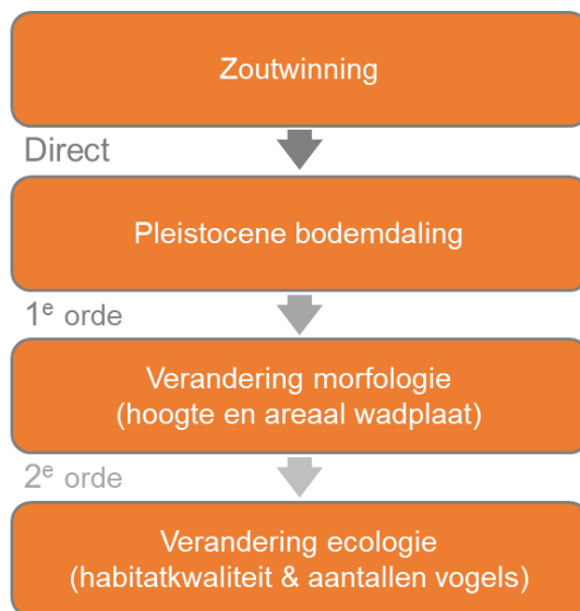
Figuur 2-5 Schema met de onderlinge afhankelijkheid tussen Zoutwinning, Pleistocene bodemdaling en veranderingen in de morfologie en in de ecologie.
