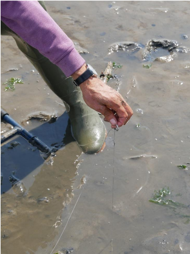
Figuur 10-2 Touwtje met ring, dat is bevestigd aan een spijker die in de ondergrond is verankerd (uit Van der Zee et al., 2018a).
