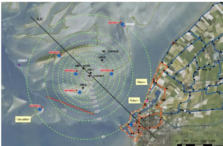
Figuur 6-7 Zwarte lijn: dwarsdoorsnede door de voorspelde bodemdalingsschotel die is doorgetrokken tot in Harlingen. De rode en blauwe lijnen met zwarte stippen op het vasteland geven het netwerk van de waterpassingen weer.
