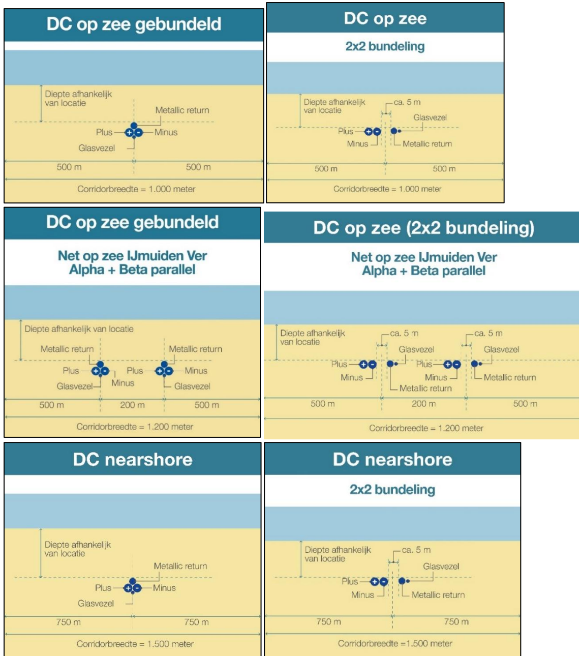
Figuur 2-1 (1x4)-kabelconfiguratie op zee (links) en (2x2)-kabelconfiguratie op zee (rechts) voor verschillende delen van het tracé: op zee (boven), op zee bij parallellegging Alpha en Beta (midden) en vlak bij de kust (onder).
