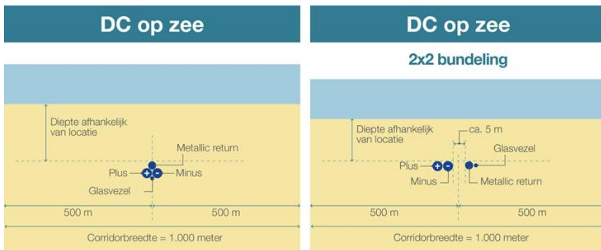
Figuur 2-1 (1x4)-kabelconfiguratie op zee (links) en (2x2)-kabelconfiguratie op zee (rechts)
