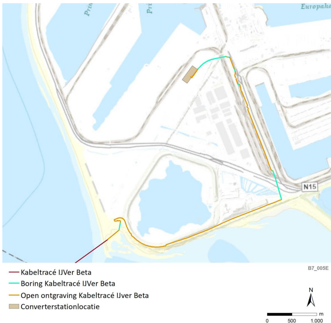
Figuur 5-4 Ligging van het VKA-tracé op land en aanlegmethode door middel van boring of open ontgraving
