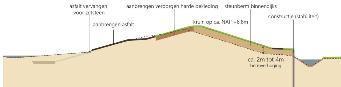
Afbeelding 3.4 Voorbeeld variant 2A: harde bekleding en constructie
