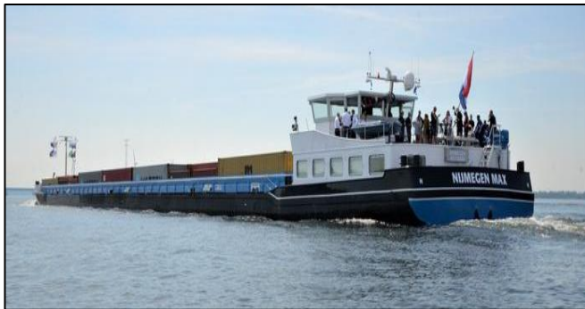
juli 2020, elektrisch aangedreven binnenvaartschip, accu's door zonne- en windenergie gevoed
