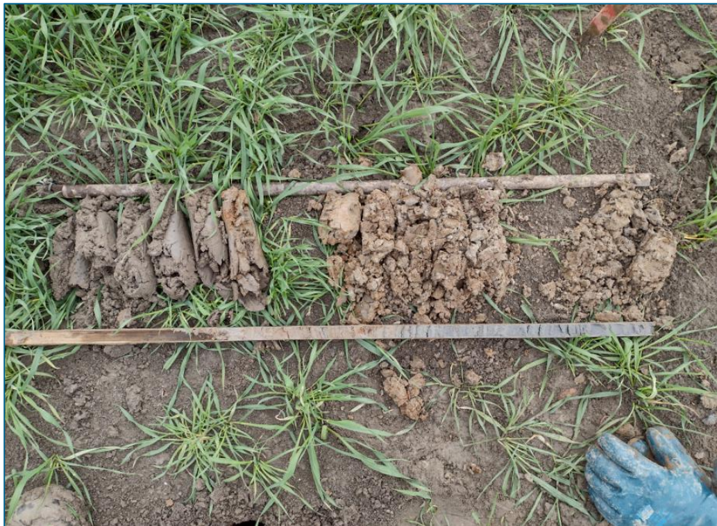
Afbeelding 23. Doorsnede van het boorprofiel ter hoogte van de geul (boring 305: verdeling bovenste rij Edelmanboring 0-0,5 m -mv, 0,5-1,0 m -mv, 1,0-1,2 m -mv; onderste rij gutsboring 1,2-2,0 m -mv). Onder de ploegvoor (tot 0,4 m -mv) een half gerijpte, beigegrijze kleiige afzetting die op de zandlaagjes breekt (tot 1,5 m -mv), gelegen op met zand en kleilagen gelamineerde blauwgrijze geul-/wadafzettingen (in de guts).
